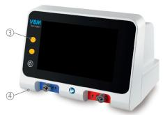
A continuación, el equipo emitirá una alarma óptica ③ y un tono de alarma ④.
