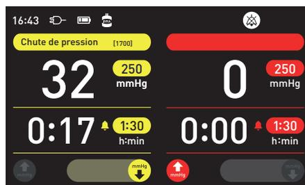
L'erreur est affichée dans la barre de canal. Le canal de brassard à contrôler alterne entre la couleur du canal et la couleur jaune.
