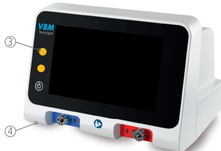
Na kraju testiranja uređaj ispušta jedan vizualni alarm ③ i jedan zvučni alarm ④.
