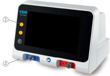
Em seguida, o dispositivo dispara um alarme ótico  $\ensuremath{\Im}$  e um som de alarme  $\ensuremath{\Phi}$ .
