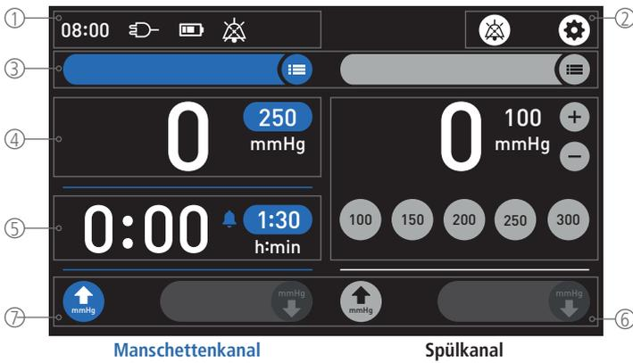
Die Hauptanzeige ist aufgeteilt in ① Statusleiste, ② Kontrollleiste, ③ Kanalleiste, ④ Bedienfeld für Druck (Manschettenkanal), ⑤ Bedienfeld für Alarmzeit (Manschettenkanal), ⑥ Bedienfeld für Druck (Spülkanal) und ⑦ Bedienfeld für Belüftung / Entlüftung. Der Manschettenkanal und der Spülkanal haben einen eigenen Druckluftkreislauf. Beide Kanäle können unabhängig voneinander bedient werden.
