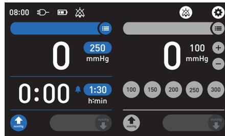
Bei erfolgreichem Selbsttest wird im Display die Hauptanzeige angezeigt.
