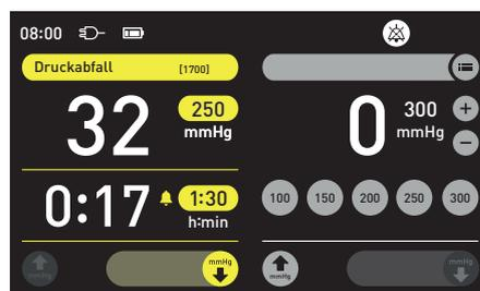
In der Kanalleiste wird der Fehler eingeblendet. Der Manschettenkanal wechselt zwischen Kanalfarbe und gelb.
