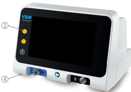
Anschließend löst das Gerät einen optischen Alarm ③ und einen Alarmton ④ aus.
