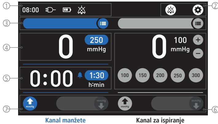
Glavni zaslon je podijeljen na ① traku statusa, ② kontrolnu traku, ③ traku kanala, ④ upravljačko polje za tlak (kanal manžete), ⑤ upravljačko polje za vrijeme alarma (kanal manžete), ⑥ upravljačko polje za tlak (kanal za ispiranje) i ⑦ upravljačko polje za punjenje/praznjenje zraka.
