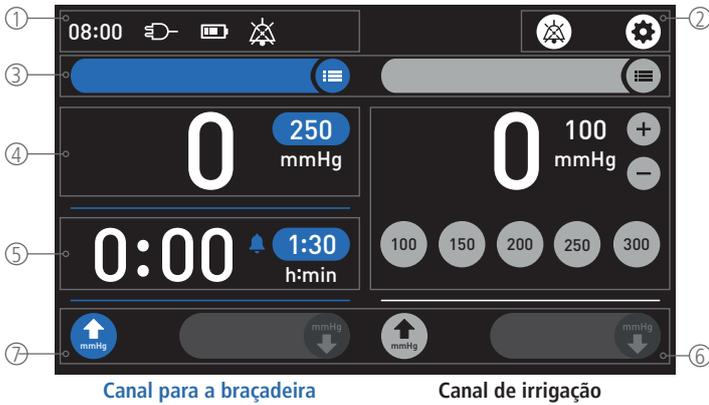
O ecrã principal está dividido em ① barra de estado, ② barra de controlo, ③ barra de canais, ④ painel de controlo da pressão (canal para a braçadeira), ⑤ painel de controlo do tempo de alarme (canal para a braçadeira), ⑥ painel de controlo da pressão (canal de irrigação) e ⑦ painel de controlo para insuflar/desuflar.
